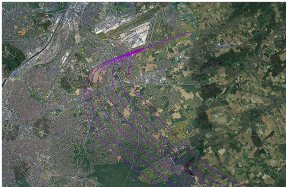
Figure 97 : Nouvelles backbone track et subtracks avec l'extension de la piste de 900 m vers l'Est
